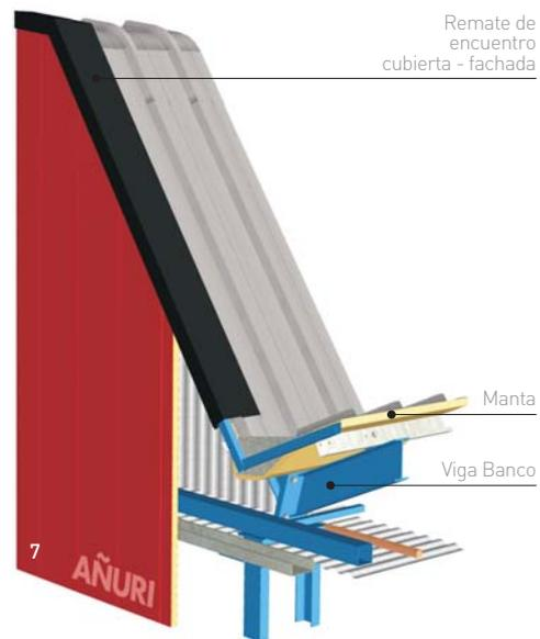
**6** Sección constructiva de una falsa terraza en la cubierta de una V2B ocultando los piñones.
